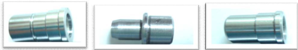
รูปที่ 3.3 รูปงานชิ้นงานที่ไม่มีการอบชุบแข็ง (No Heat and Surface Treatment)
