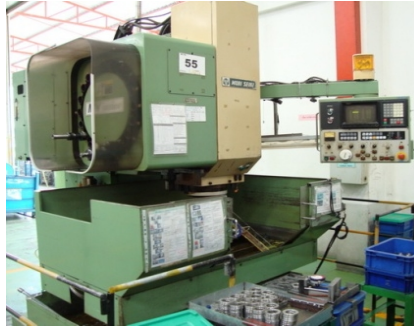
รูปที่ 3.10 เครื่องจักรซีเอ็นซี (CNC Milling Machine)
