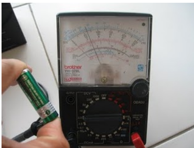
รูปที่ 2.6 การใช้มิเตอร์แบบแอนะล็อกวัดแรงดันไฟฟ้าตรง
