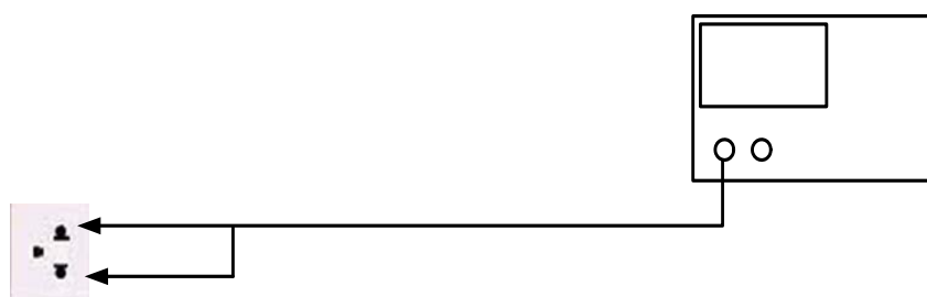
รูปที่ 2.14 การใช้ฮอสซิลโลสโคปวัดแรงดันไฟสลับ
