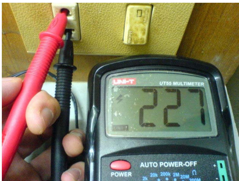
รูปที่ 2.9 การใช้ดิจิตอลมิเตอร์วัดแรงดันไฟสลับ
