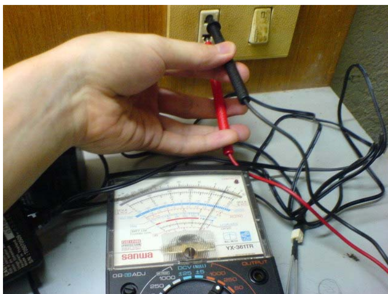
รูปที่ 2.8 การใช้แอนะล็อกมิเตอร์วัดแรงดันไฟสลับ
