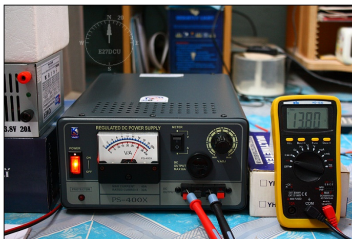
รูปที่ 2.7 การใช้จิจิตอลมิเตอร์วัดแรงดันไฟตรง
