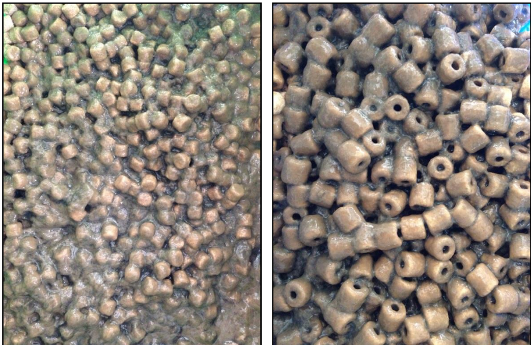
รูปที่ 4.13 (A.) ปฏิกรณ์ที่ใช้ตรึงฟิล์มขนาด 60 ลิตร (B.) ตัวกลางที่ใช้ในการตรึงฟิล์ม (ซ่าย Kaolinite silica, ขาว Ceramic ring)
