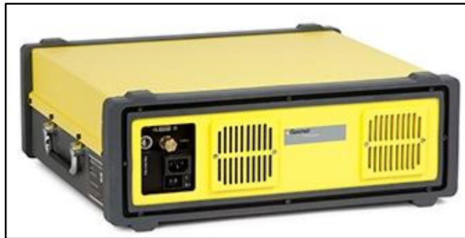
รูปที่ 2.15 เครื่องวิเคราะห์แก๊ส FTIR
