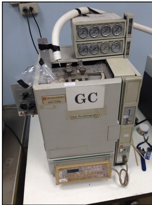
รูปที่ 2.14 แก๊สโครมาโทกราฟีรุ่น GC-14BFIDยี่ห้อ Shimadzu
