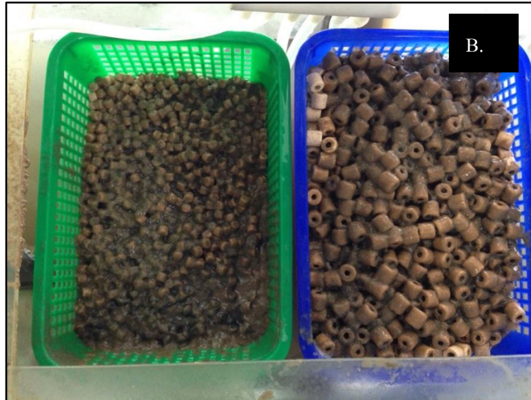
รูปที่ 4.13 (A.) ปฏิกรณ์ที่ใช้ตรึงฟิล์มขนาด 60 ลิตร (B.) ตัวกลางที่ใช้ในการตรึงฟิล์ม (ซ่าย Kaolinite silica, ขาว Ceramic ring)
