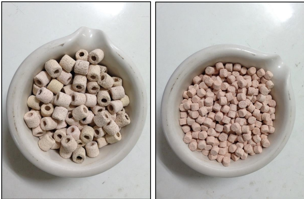
รูปที่ 3.7 เซรามิกริง (Ceramic ring) (ซ้าย) และ Kaolinite Activated Silica (KAS) (ขวา)
