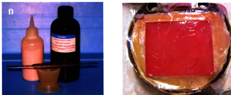
ภาพที่ 3 (ก) วัสดุเรซินอะคริลิกและอุปกรณ์ในการผสม (ข) การหล่อแบบเพื่อขึ้นรูปแผ่นอะคริลิก
