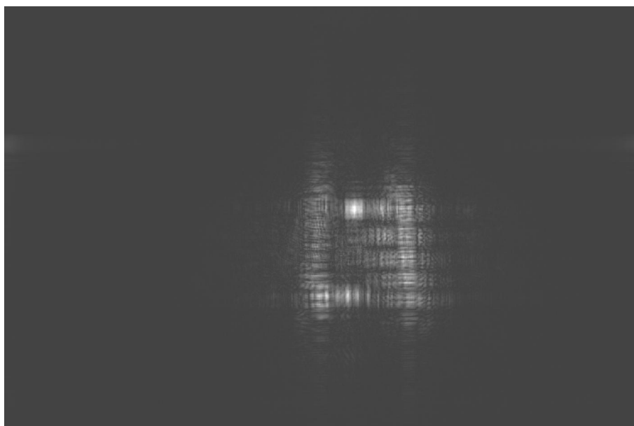
ภาพที่ 4.10 ภาพโฮโลแกรมของแผ่น USAF ที่สร้างขึ้นที่ระยะ 200 มิลลิเมตร
