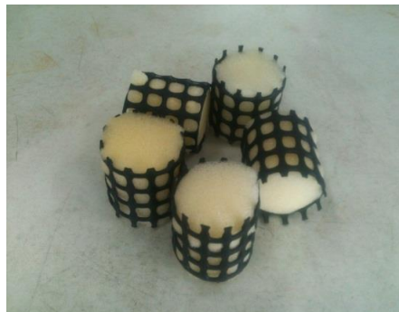
รูปที่ 3.2 ตัวกลางฟองน้ำที่ใช้ในถังปฏิกรณ์ระบบ DHS
