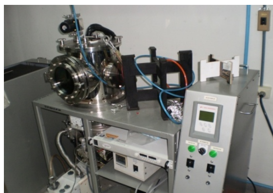
ภาพที่ 3.1 แสดงภาพถ่ายของระบบการระเหยสารเคมีด้วยความร้อนในระบบสุญญากาศ
