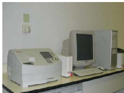
ภาพที่ 3.4 แสดงภาพถ่ายเครื่อง UV-VIS ยี่ห้อ Thermo electron corporation รุ่น He \lambda ions \alpha
