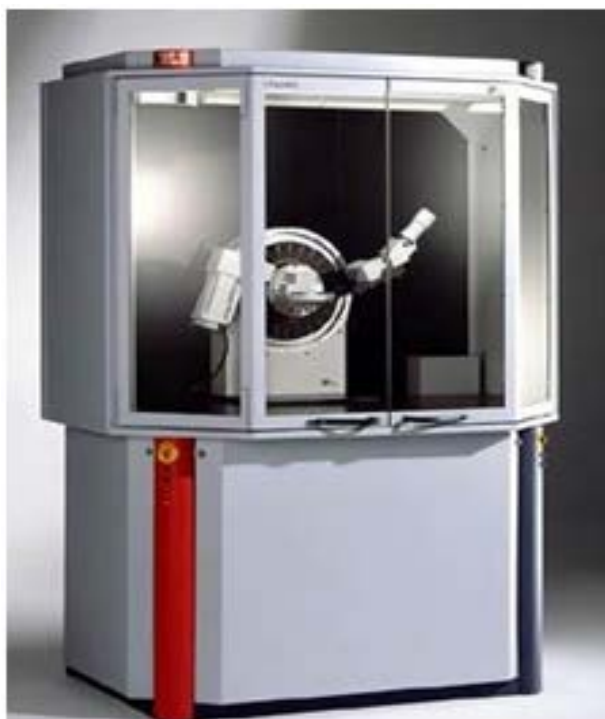
ภาพที่ 3.3 แสดงภาพถ่ายเครื่องเอกซเรย์ดิฟแฟร็กโทรมิเตอร์ยี่ห้อ Bruker รุ่น D8 Advance
