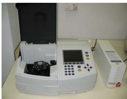
ภาพที่ 3.4 แสดงภาพถ่ายเครื่อง UV-VIS ยี่ห้อ Thermo electron corporation รุ่น He \lambda ions \alpha
