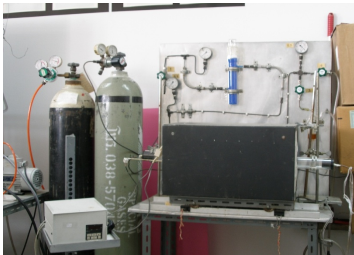
ภาพที่ 3.2 แสดงระบบเตาแอนนัลที่สามารถใช้งานได้ถึง 900 องศาเซลเซียสภายใต้บรรยากาศของก๊าซไนโตรเจนบริสุทธิ์
