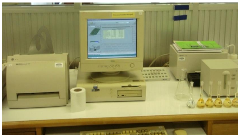
รูปที่ 3-4 แสดงเครื่อง UV-vis Spectrophotometer รุ่น (HEWLETT PACKARD 8453) สำหรับใช้วิเคราะห์หาเหล็กเฟอรัส \text{Fe}^{2+} และความเข้มข้นสีในน้ำเสีย
