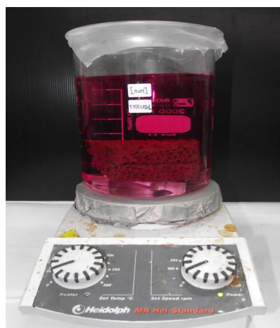
รูปที่ 3-12 ชุดการทดลองการกำจัดสีย้อมจากน้ำสีสังเคราะห์แบบเบทช์ในปิกเกอร์
