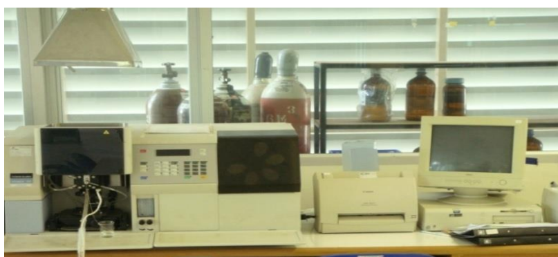
รูปที่ 3-5 แสดงเครื่อง Atomic Absorption Spectrometer (AAS) รุ่น (Perkin Elmer model AA Analyst) สำหรับใช้วิเคราะห์ปริมาณเหล็กรวม
