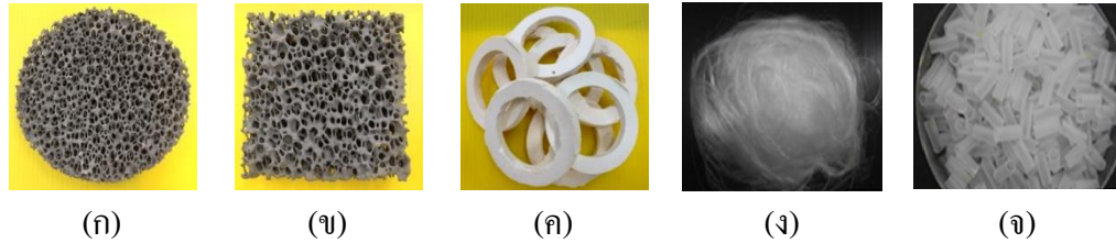
รูปที่ 2-7 แสดงวัสดุตัวกลางชนิดเซรามิกโฟมชิ้นวงกลม (ก) เซรามิกโฟมชิ้นสี่เหลี่ยม (ข) เซรามิกโฟมชิ้นวงแหวน (ค) ใยแก้ว (ง) และหลอดแก้ว (จ)
