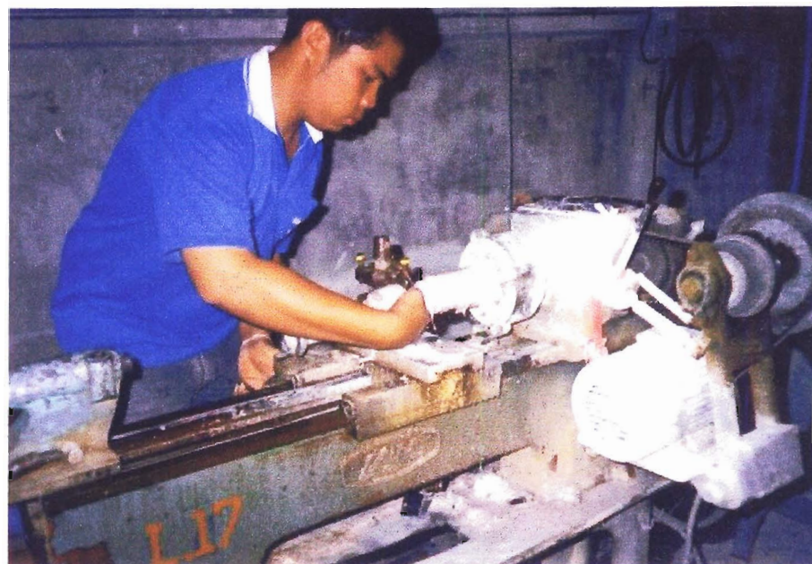
ขั้นตอนการใช้ผงขัดเงาและการตัดหินที่เสร็จออกจากเครื่อง
