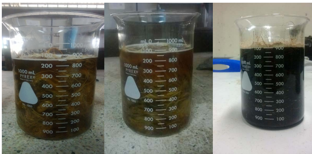
ภาพที่ 3.15 แสดงการนำเส้นใยปาล์มน้ำมัน, เส้นใยหมาก และเส้นใยกาบมะพร้าว แฉด้วยสารละลายโซเดียมไฮดรอกไซด์
