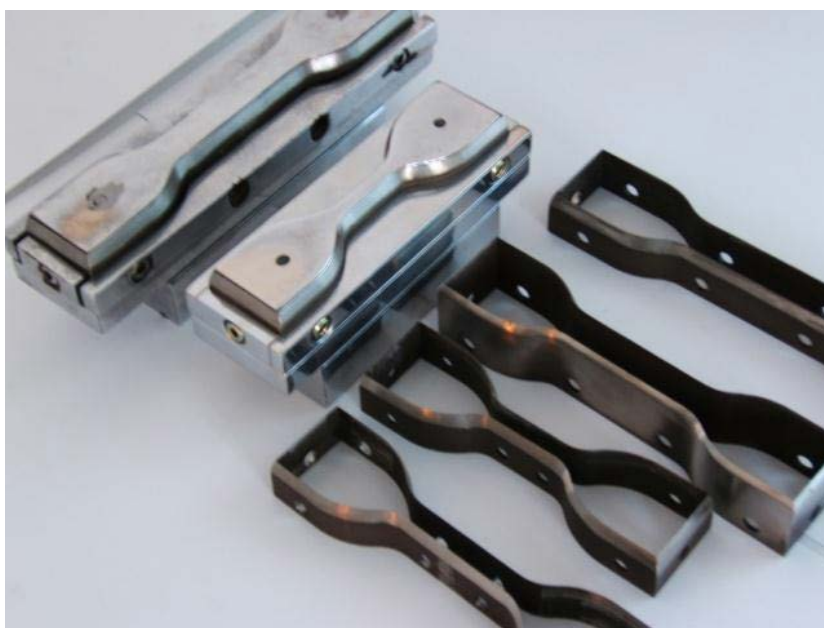
ภาพที่ 3.13 แสดงตัวอย่าง dies ที่ใช้ตัดชิ้นทดสอบรูปดัมเบลล์
