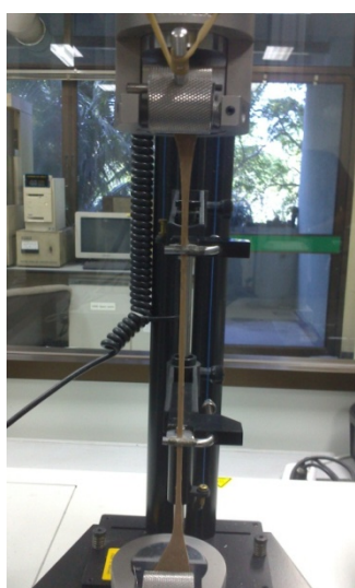
ภาพที่ 3.20 แสดงการทดสอบ Tensile Strength (ASTM D412)
