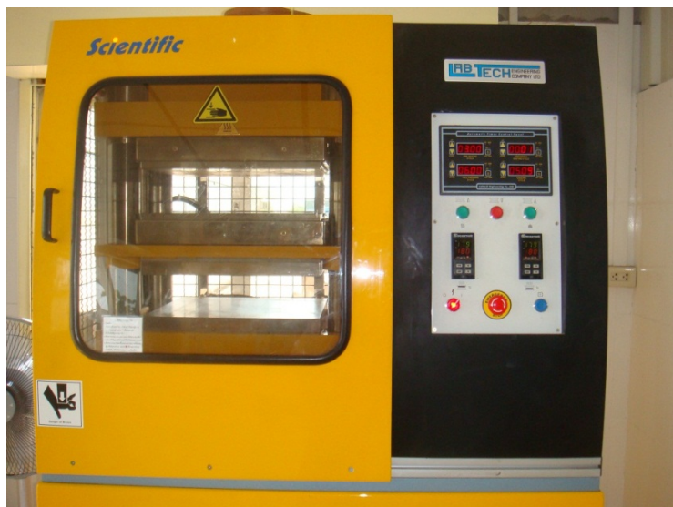
ภาพที่ 3.8 เครื่องอัดแม่พิมพ์ยางไฮดรอลิก (Compression molding)
