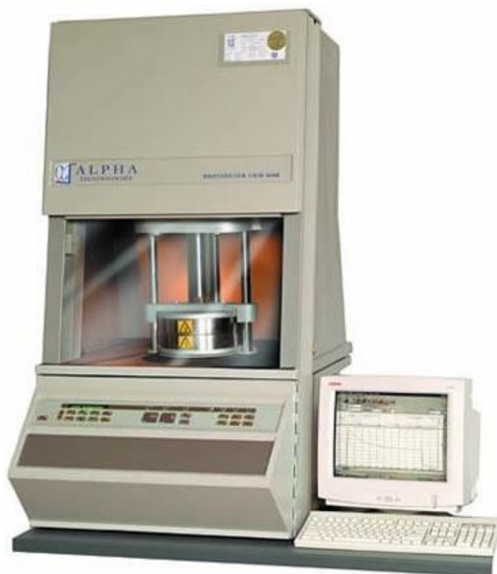
ภาพที่ 3.7 เครื่องทดสอบหาเวลาการวัลคาไนซ์ของยาง Moving Die Rheometer (MDR)
