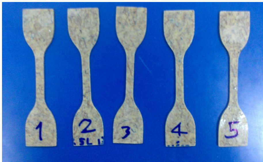
ภาพที่ 3.19 ชิ้นทดสอบรูปดัมเบลล์ (Die C) สำหรับการทดสอบความทนต่อแรงดึง
