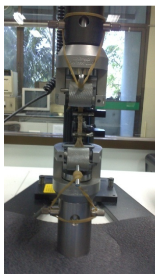
ภาพที่ 3.20 แสดงการทดสอบ Tensile Strength (ASTM D412)
