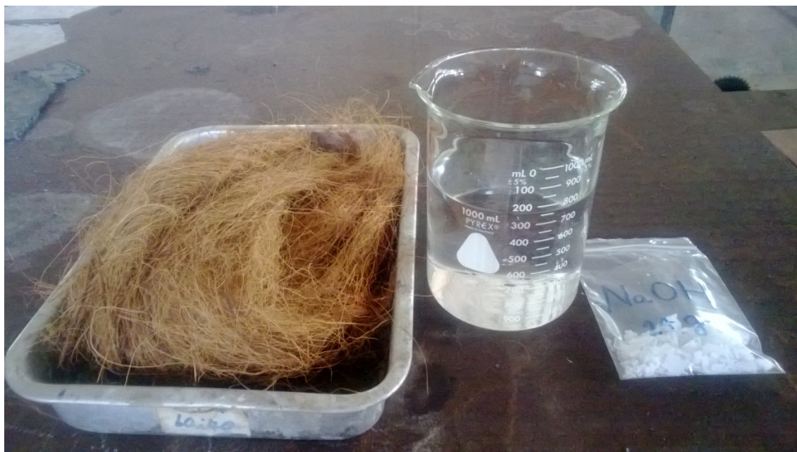
ภาพที่ 3.14 แสดงการเตรียมสารละลายโซเดียมไฮดรอกไซด์
