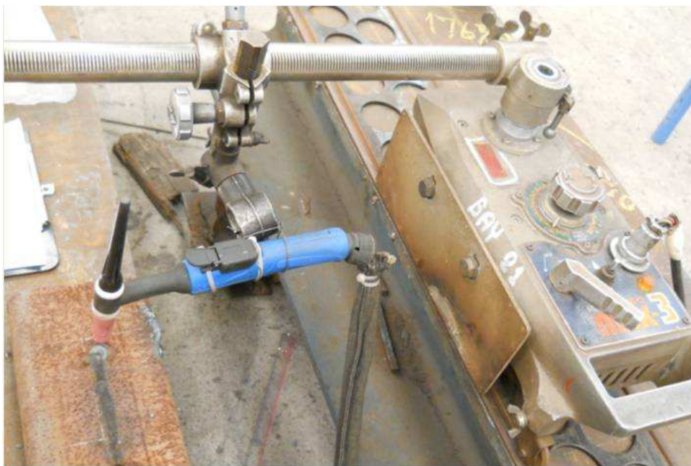
รูปที่ ก.2 การประกอบและติดตั้งหัวเชื่อมเข้ากับอุปกรณ์พาเคลื่อนที่
