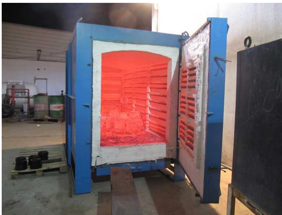
รูปที่ ก.8 การปรับปรุงโครงสร้างด้วยกรรมวิธีทางความร้อนที่อุณหภูมิ 950 องศาเซลเซียส นาน 1 ชั่วโมง และจำลองสภาวะการใช้งานที่อุณหภูมิ 600 องศาเซลเซียส นาน 24 ชั่วโมง
