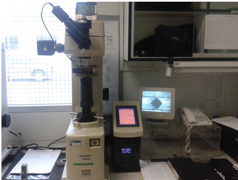
รูปที่ ก.10 เครื่องกดเพื่อวัดค่าความแข็งแบบ Vickers Hardness
