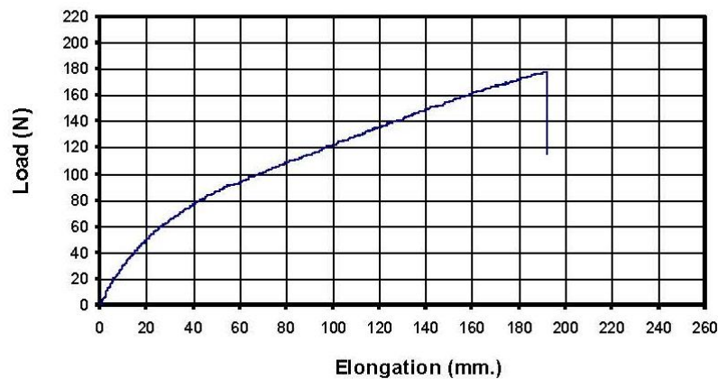
รูปที่ 2.9 ตัวอย่างกราฟความสัมพันธ์ระหว่างแรงดึงกับระยะยืดตัว [7]
