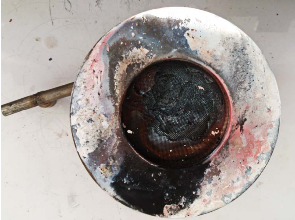
รูปที่ 5.8 ภาพถ่ายแสดงการหลอมละลายของชิ้นตาข่ายสแตนเลสใน PB
