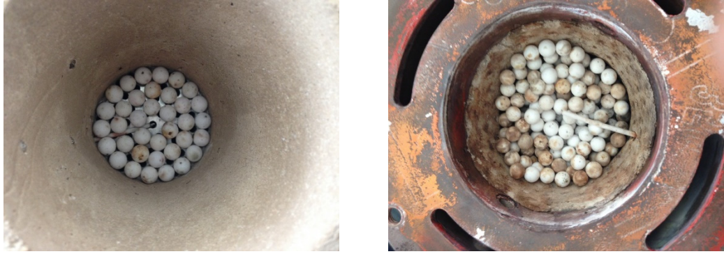
รูปที่ ก.6 รูปถ่ายการจัดเรียง Alumina ball ใน PE
