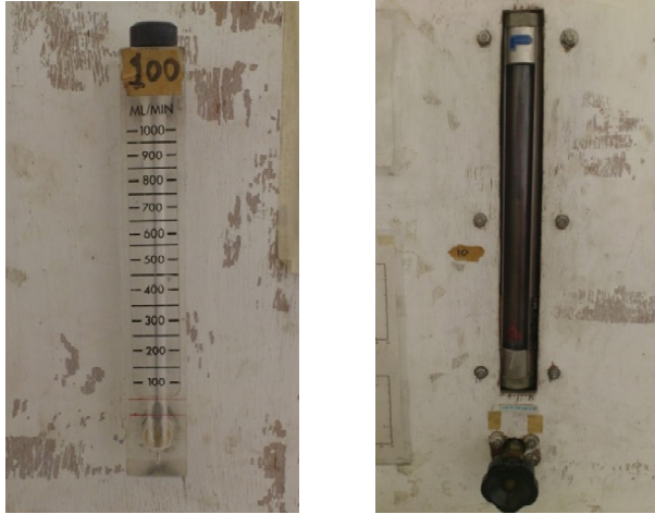
รูปที่ ก.9 รูปถ่ายอุปกรณ์วัดอัตราการไหลของแก๊ส (LPG) และอากาศ ตามลำดับ
