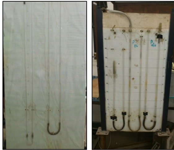
รูปที่ ก.15 รูปถ่ายอุปกรณ์วัดความดัน (U-tube manometer)
