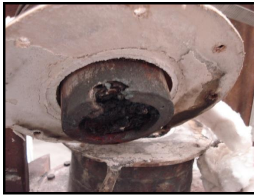
รูปที่ 1.1 การหลอมละลายของหัวเผาวัสดุพูนในงานวิจัยของ พีรพงษ์ โตขลิบ [14]
