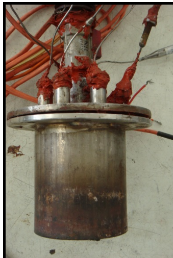
รูปที่ 1.2 การขยายตัวทางความร้อนของหัวเผาวัสดุพูนในงานวิจัยของของ พีรพงษ์ โตขลิบ [14]
