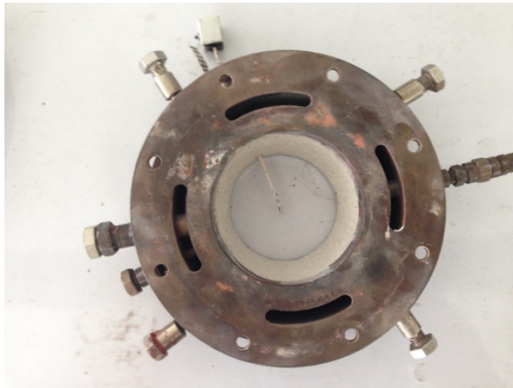
รูปที่ ก.4 รูปถ่าย Combustor block (CB) พร้อม Cement liner
