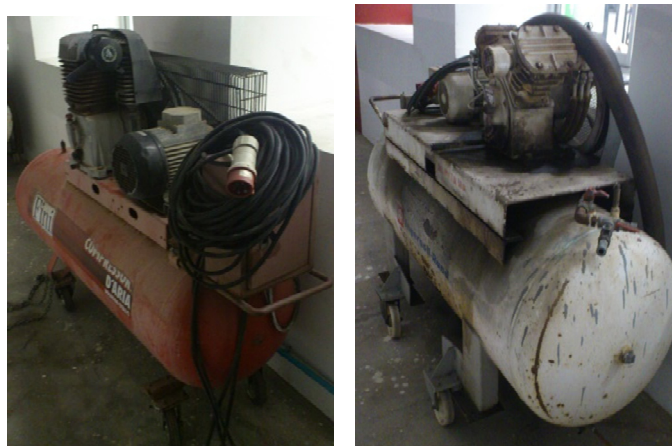
รูปที่ ก.16 รูปถ่ายอุปกรณ์จ่ายอากาศ (Air-compressor)
