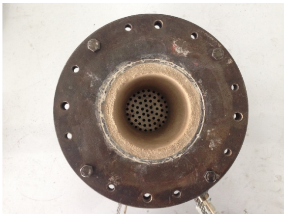
รูปที่ ก.5 รูปถ่าย Porous emitter (PE) พร้อม Cement liner
