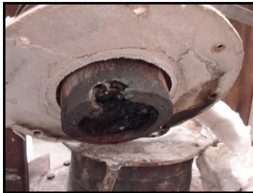
รูปที่ 1.1 การหลอมละลายของหัวเผาวัสดุพอรุนในงานวิจัยของ พีรพงษ์ โตขลิบ [14]
