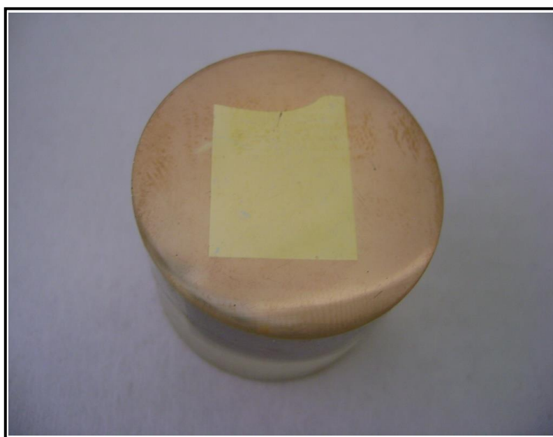
ค.5 ชิ้นงานที่ทำMountนำไปทำการขัดและกัดกรดเพื่อส่องดูโครงสร้างจุลภาค
