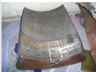
ชิ้นงานที่พบรอย Crack นำไปตัดทอนให้เล็กลง
