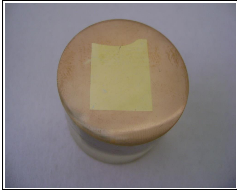
รูปที่ 3.19 นำชิ้นงานที่พบรอยแตกร้าวไปตัดด้วยเครื่องตัดขนาดเล็กและทำเรือนหุ้มแบบ Cold Mount
