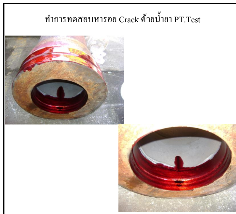
รูปที่ 3.15 ชิ้นงานที่นำมาตรวจสอบหาตำแหน่งการแตกร้าว
