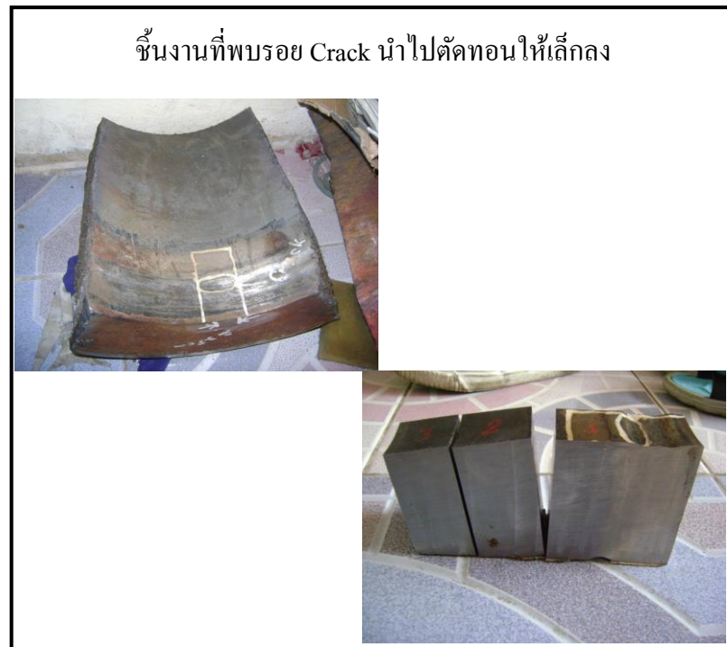
รูปที่ 3.17 นำชิ้นงานที่พบรอยแตกร้าวและทำการMarkไปตัดทอนด้วยเครื่องตัดขนาดใหญ่
