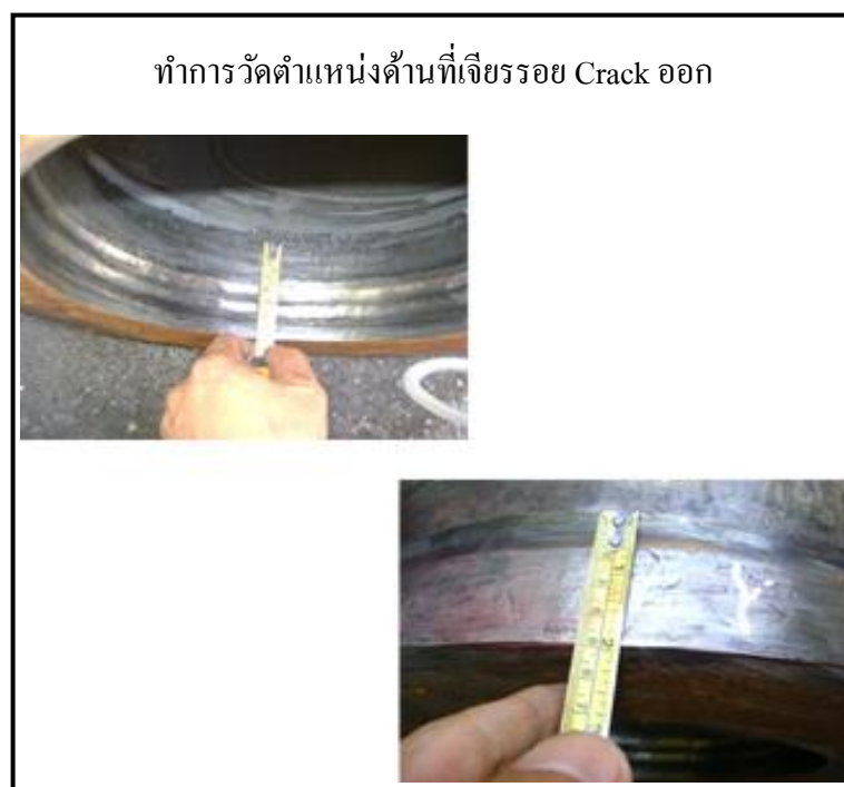
รูปที่ 3.14 ทำการวัดตำแหน่งด้านนอกที่เจียรรอยร้าวออกลึกประมาณ 50 mm.
