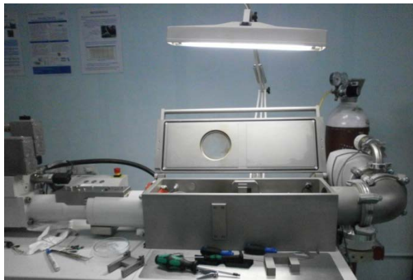
รูปที่ 3.7 รูปภาพแสดงส่วนประกอบหลักของเครื่องไดลาโตมิเตอร์
