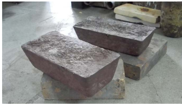
รูปที่ 3.2 โลหะผสมนิกเกิลอะลูมิเนียมบรอนซ์ที่ได้จากการหล่อ
