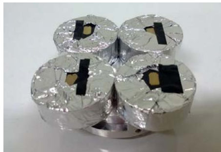
รูปที่ 3.10 ชิ้นงานโลหะผสมนิกเกิลอะลูมินัมบรอนซ์สำหรับการตรวจสอบโครงสร้างจุลภาค
