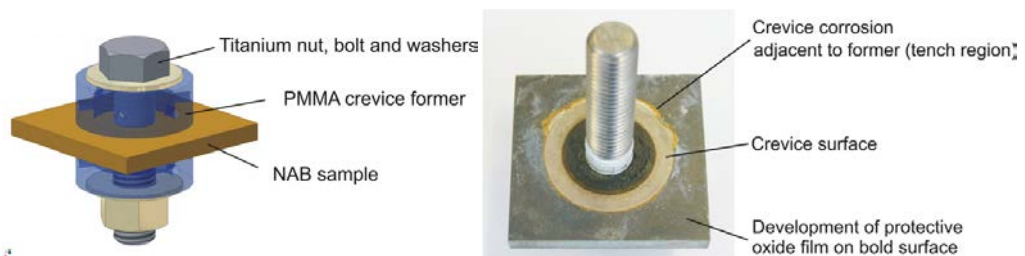
รูปที่ 2.4 การทดสอบการกัดกร่อนบริเวณรอยแยกของโลหะผสมนิกเกิลอะลูมิเนียมบรอนซ์
