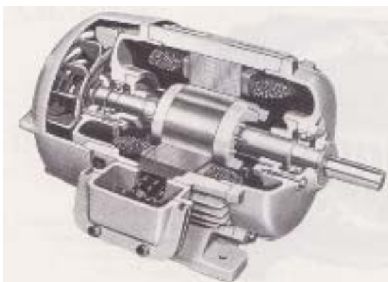
รูปที่ 2.14 มอเตอร์เหนี่ยวนำสามเฟสโรเตอร์กรงกระรอก
