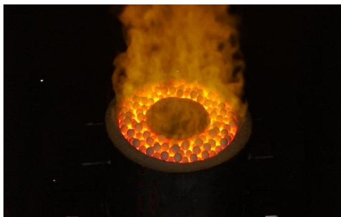
รูปที่ 5.3 ลักษณะเปลวไฟของเชื้อเพลิง LPG เห็นยวนำอากาศด้วยตัวเอง
