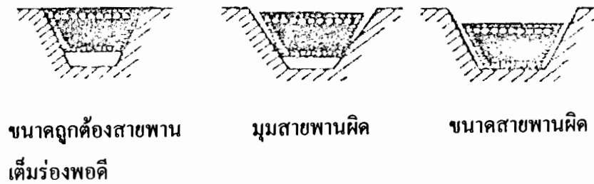
รูปที่ 2.31 ลักษณะการเลือกสายพานให้เหมาะสมกับร่องสายพาน
