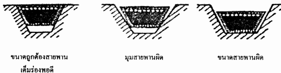
รูปที่ 2.26 ลักษณะการเลือกสายพานให้เหมาะสมกับร่องสายพาน
