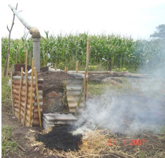
รูปที่ 3.18 การจุดไฟหน้าเตาและการใส่เชื้อเพลิง
