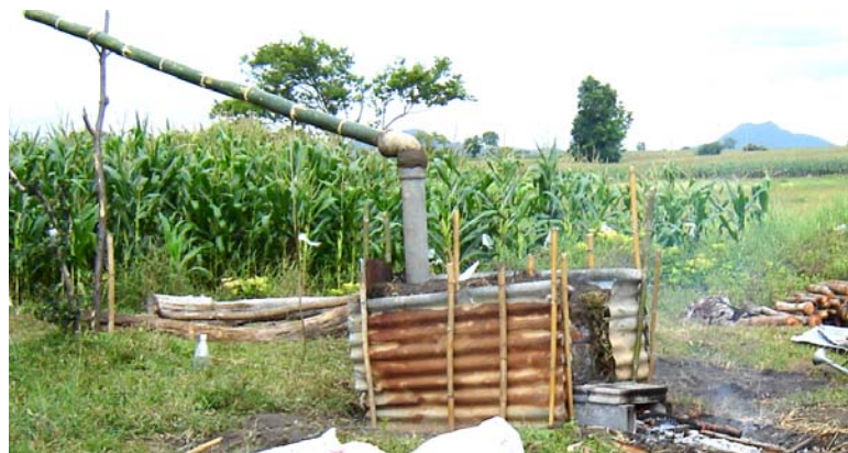
รูปที่ 3.25 กระบวนการเก็บน้ำส้มควันไม้
