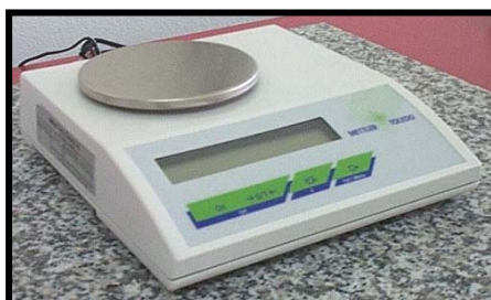
รูปที่ 3.1 เครื่องชั่งไฟฟ้า 1 ตำแหน่ง ชื่อ METTLER-TOLEDO GmbH แบบและหมายเลข คือ BD601
