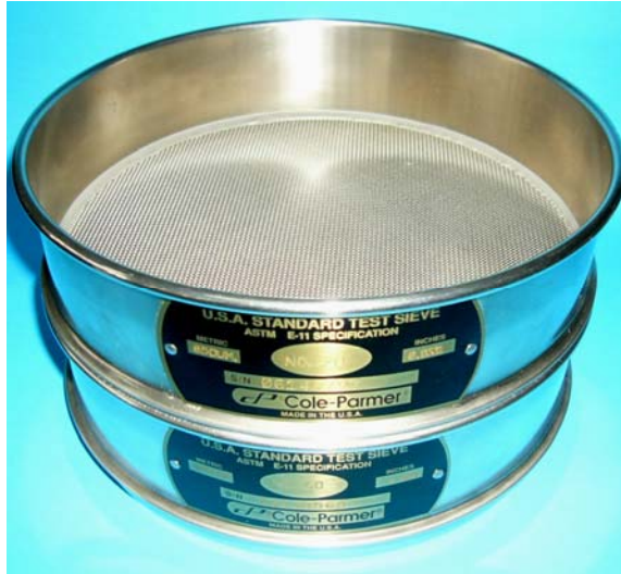
รูปที่ 2.1 ตะแกรงร่อน TEST SIEVE 8"-FH-SS-SS-US-20 ซ้อนบนตะแกรงขนาด 8"-FH-SS-SS-US-60
