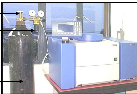
รูปที่ 2.3 รูปบอมบ์แคลอรีมิเตอร์ Model C-5000 Serial No. 10.002704 กับถังแก๊สออกซิเจน
