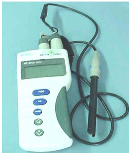
รูปที่ 3.7 พีเอชมิเตอร์ชื่อ METTLER TOLEDO แบบและหมายเลขคือ MP 120FK
