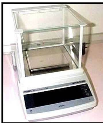
รูปที่ 3.3 เครื่องชั่งไฟฟ้า 3 ตำแหน่ง ชื่อ METLLER-TOLEDO GmbH แบบและหมายเลข คือ PG203-S
