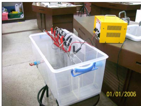
รูปที่ 3.17 แสดงการต่อเครื่องชาร์จแบตเตอรี่กับขั้วไฟฟ้าอะลูมิเนียมในถังตกตะกอน
