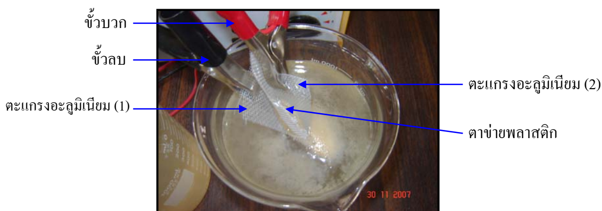
รูปที่ 3.10 แสดงการต่อขั้วบวกและลบเข้ากับขั้วไฟฟ้าอะลูมิเนียมของตัวอย่างน้ำทิ้งจากแม่น้ำเจ้าพระยาที่ได้จากตลาดสะพานดำ จ. นครสวรรค์
