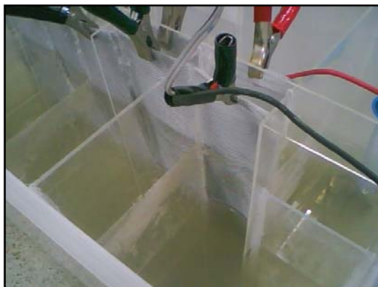
รูปที่ ข.4 แสดงการตกตะกอนน้ำทิ้งจากแม่น้ำเจ้าพระยาที่ได้จากตลาดสะพานดำ จังหวัดนครสวรรค์ ด้วยอุปกรณ์ต้นแบบในการบำบัดน้ำเสียด้วยไฟฟ้าเคมี
