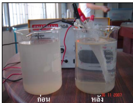
รูปที่ ข.1 แสดงน้ำจากแม่น้ำเจ้าพระยาที่ได้จากตลาดสะพานดำ จังหวัดนครสวรรค์ ก่อนและหลัง ตกตะกอนด้วยไฟฟ้าเคมี โดยใช้ขั้วไฟฟ้าอะลูมิเนียม
