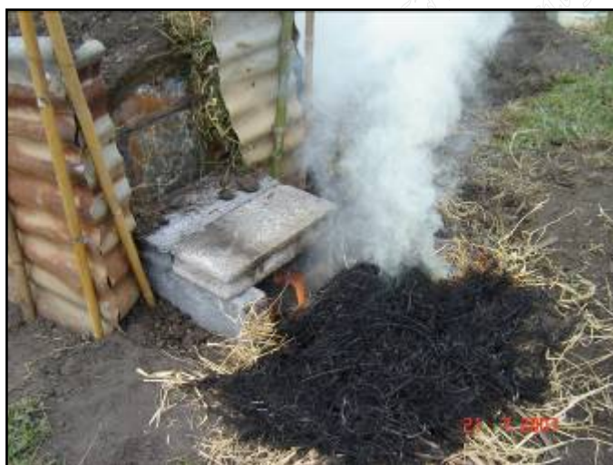
รูปที่ 3.5 แสดงการจุดไฟหน้าเตาเพื่อให้ความร้อนแก่เตา
