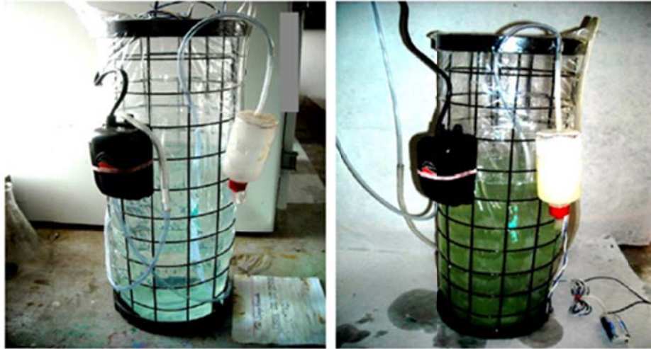
ภาพที่ 2.7 Photobioreactors ในการเลี้ยงสาหร่ายขนาดเล็ก ที่มา : Narwade et al. (2011)
