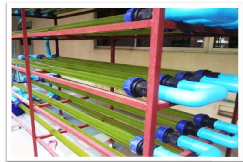
ภาพที่ 3.3 horizontal tubular photobioreactor สำหรับการเพาะเลี้ยง B. braunii
