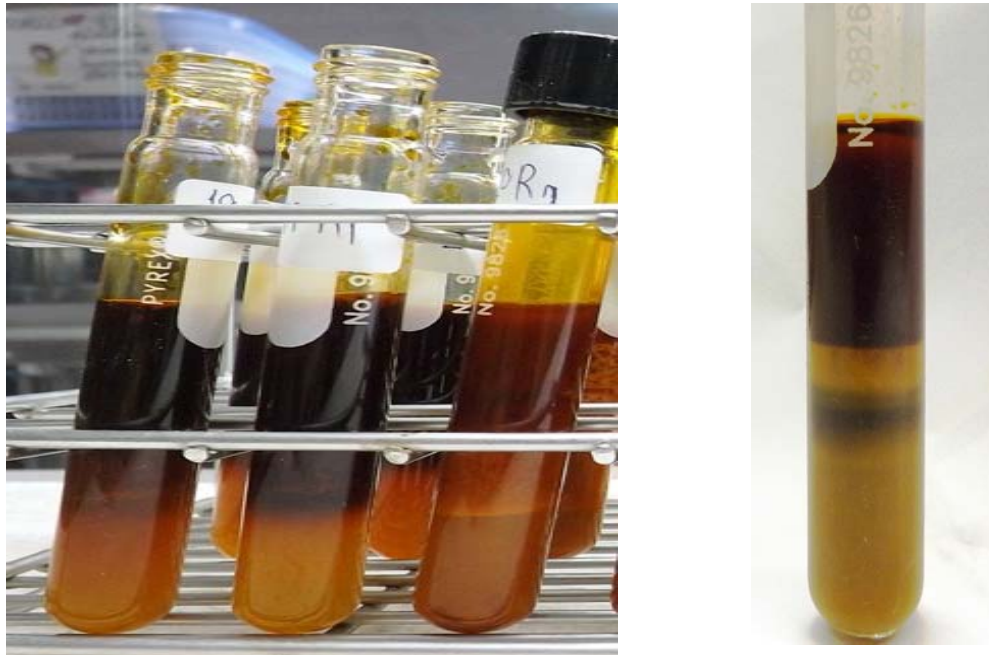
ภาพที่ 4.46 ปริมาณน้ำมันไพโรทีเซล (ด้านบนของหลอด) และกลีเซอริน (ด้านล่างของหลอด)
