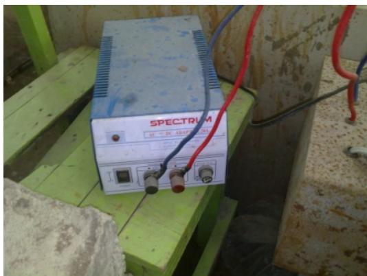
รูปที่ 3.6 เครื่องควบคุมกระแสไฟฟ้าและกระจายกระแสไฟฟ้าเพื่อเร่งปฏิกิริยาสนิม
