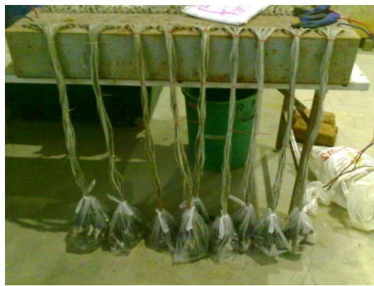
รูปที่ 3.6 เครื่องควบคุมกระแสไฟฟ้าและกระจายกระแสไฟฟ้าเพื่อเร่งปฏิกิริยาสนิม
