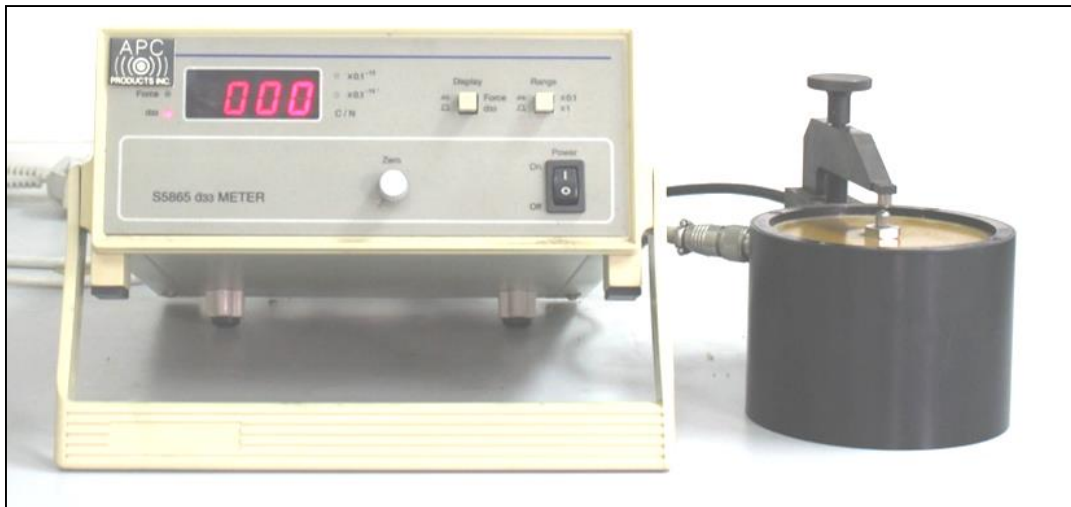
รูปที่ 3.22 เครื่อง d_{33} Meter ที่อาคารปฏิบัติการวิศวกรรมเซรามิก
