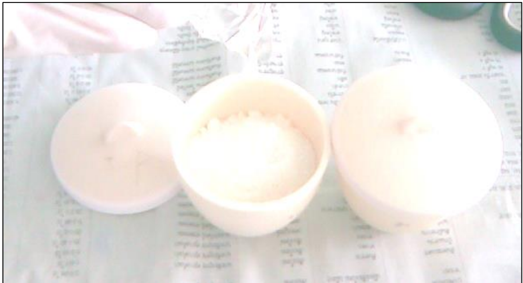
รูปที่ 3.6 ผงสารสังเคราะห์บรรจุในภาชนะเผา (alumina crucible) สำหรับเผาให้ความร้อน (calcine) และเผาผนึก (sintering)
