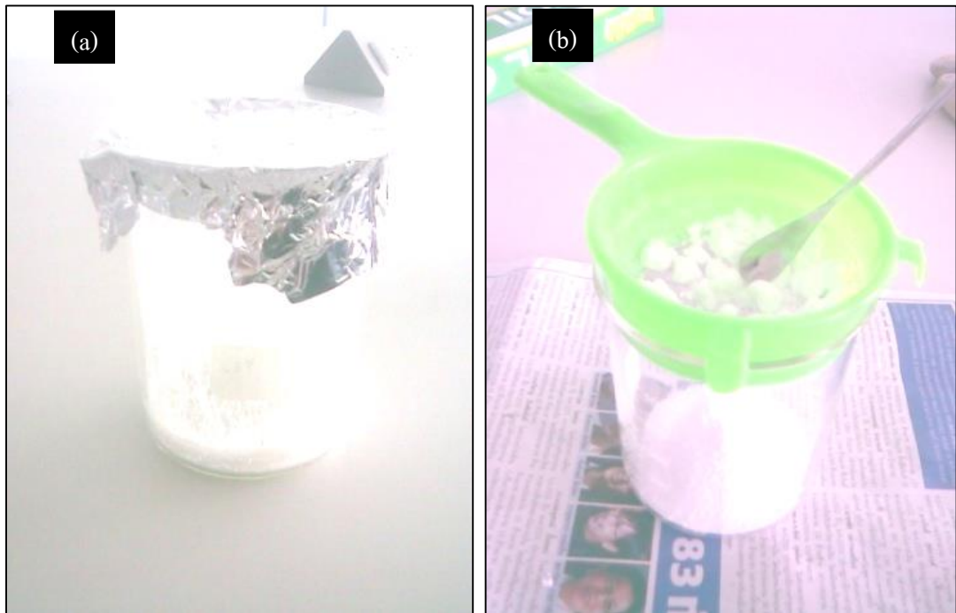
รูปที่ 3.5 (a) สารสังเคราะห์หลอมแห้งที่จับกันเป็นก้อน (b) การบดย่อยให้เป็นผง
