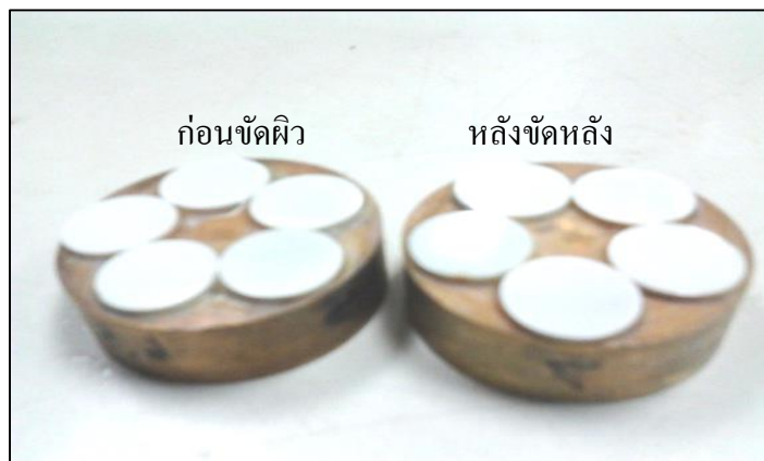
รูปที่ 3.13 ชิ้นงานตัวอย่างก่อนขัดและหลังขัดผิวหน้า
