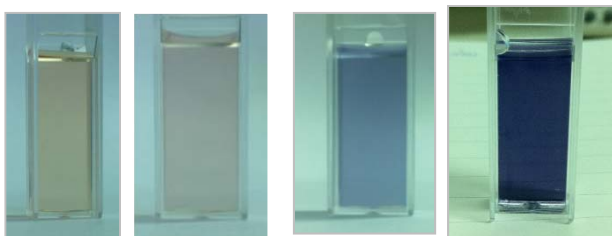
รูปที่ 3 ผลิตภัณฑ์สีที่ได้จากปฏิกิริยาเคมีของเมทแอมเฟตามีนและน้ำยาเคมีไซมอน (ซ้ายมือ:แบลงค์)
