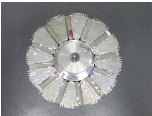
(ก) การยัดแท่งแม่เหล็กถาวรเข้ากับแกนโรเตอร์ PWM
