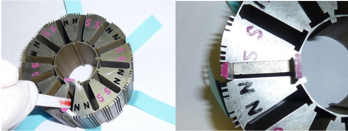
(ก) การยัดแท่งแม่เหล็กถาวรเข้ากับแกนโรเตอร์ PWM
