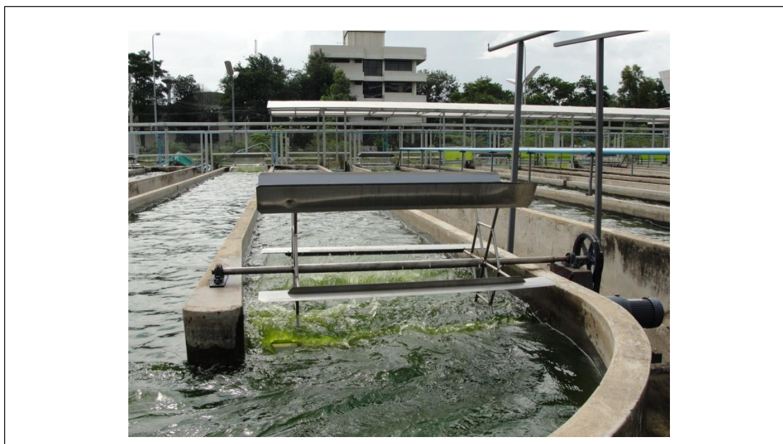
รูปที่ 4.12 แสดงบ่อเพาะเลี้ยงสาหร่ายระบบบ่อเปิดแบบรางคู่
