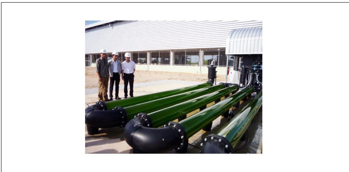
รูปที่ 4.13 แสดงท่อเพาะเลี้ยงสาหร่ายด้วยเครื่องปฏิกรณ์ชีวภาพแบบแสง
