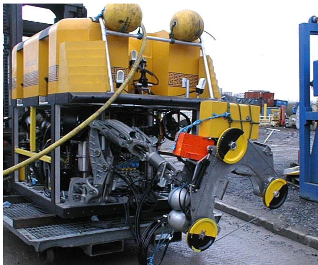
รูปที่ 2.11 อุปกรณ์ตัดเลื่อยวงลาวคากเพชร [23]
