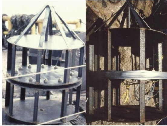
รูปที่ 2.14 การใช้ระเบิดตัด (Explosive Cutting) [23]
