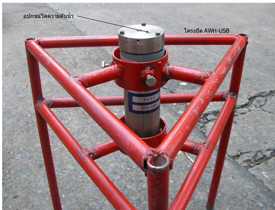
รูปที่ 4.2 อุปกรณ์วัดคลื่นระดับลิวเอช-ยูเอสบี
