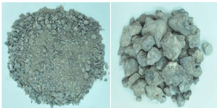
รูปที่ 4.5 มวลรวมละเอียดและมวลรวมหยาบจากเศษคอนกรีต
