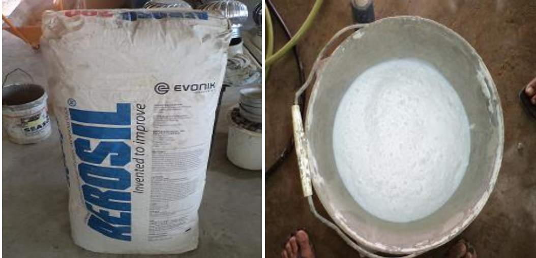
รูปที่ 3.4 นาโนซิลิกา (Nano-SiO 2 ) ขนาดอนุภาค 12 นาโนเมตร
