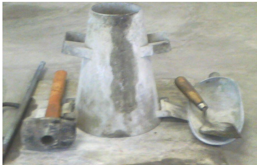
รูปที่ 3.10 ชุดทดสอบค่าการยุบตัวของคอนกรีต (Slump test)
