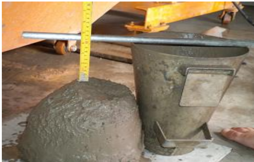
รูปที่ ค.4 การวัดค่าการยุบตัวของคอนกรีต
