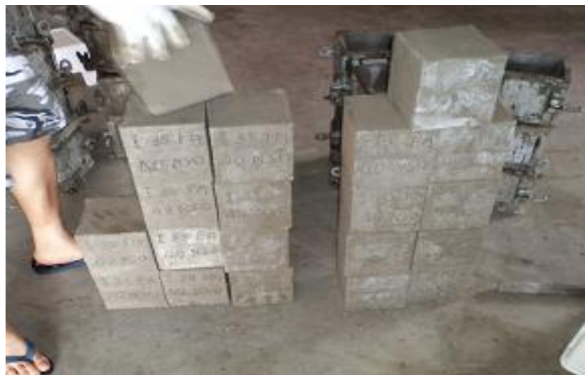
รูปที่ ค.8 การนำตัวอย่างออกจากแบบหล่อคอนกรีต
