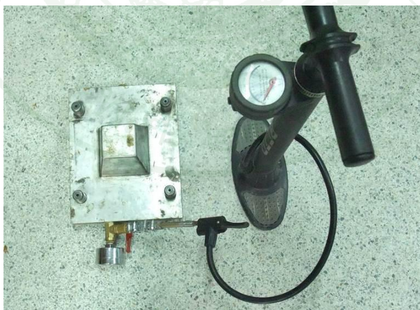
ภาพที่ 62 อุปกรณ์ทดสอบการรั่วซึมของแม่พิมพ์
