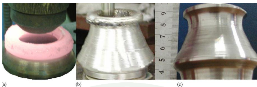
ภาพที่ 10 (a) ชิ้นงานระหว่างการเติมเนื้อวัสดุ (b) ชิ้นงานระหว่างกระบวนการกัดแต่งผิว (c) ชิ้นงานหลังผ่านกระบวนการกัดแต่งผิว
