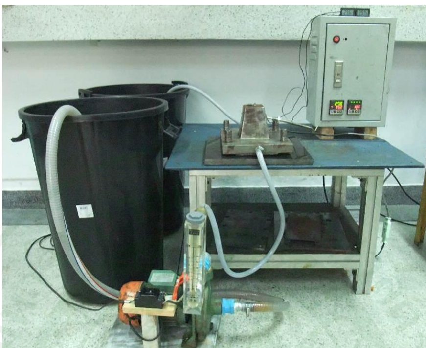
ภาพที่ 64 อุปกรณ์ทดสอบการระบายความร้อนของแม่พิมพ์ตัวผู้
