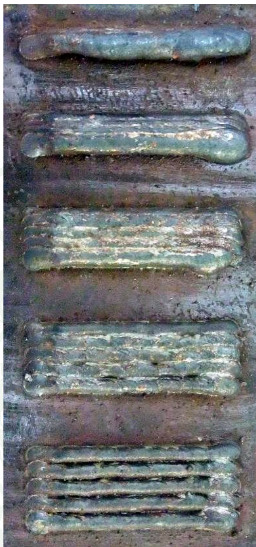
ภาพที่ 66 แสดงแนวเชื่อมขนานกันจำนวน 5 แนว โดยมีระยะห่างระหว่างแนวเชื่อม 1, 2, 3, 4 และ 5 มม. จากบนลงล่างตามลำดับ
