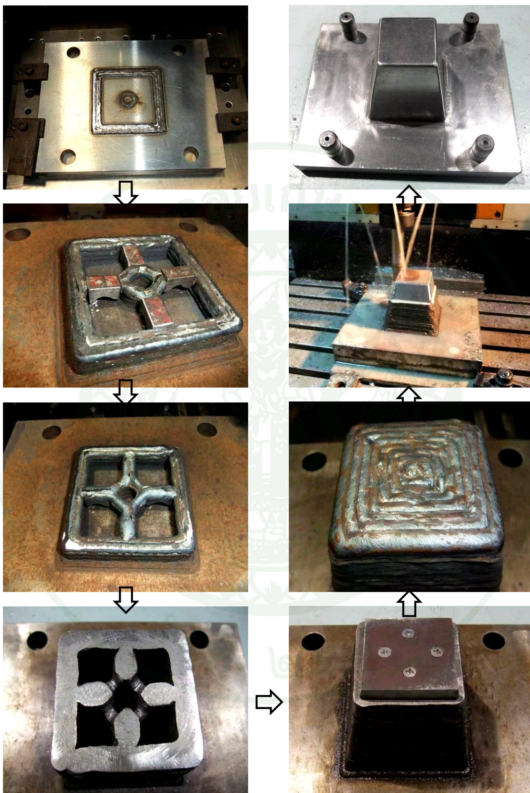
ภาพที่ 85 แสดงขั้นตอนการในการขึ้นรูปแม่พิมพ์ที่มีระบบหล่อเย็นแบบจิตผิว
