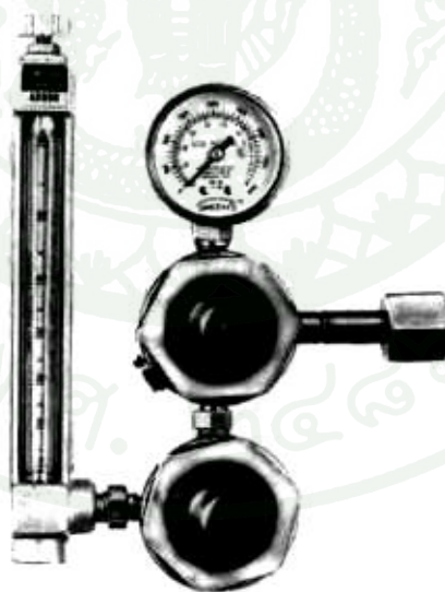
ภาพที่ 28 อุปกรณ์ควบคุมความดันและมาตรวัดการไหล
