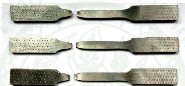
ภาพที่ 68 แสดงตัวอย่างชิ้นงานหลังจากทดสอบแรงดึงภายใต้การควบคุมอุณหภูมิ
