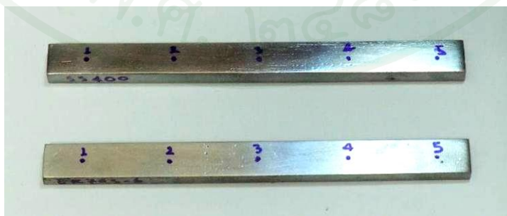
ภาพที่ 49 แสดงชิ้นงานทดสอบความแข็งแบบร็อคเวลล์
