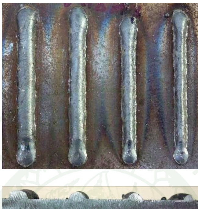
ภาพที่ 65 แนวเชื่อมที่ใช้ความเร็วหัวเชื่อม 200, 300, 400 และ 500 มม./นาทิจากซ้ายไปขวาตามลำดับ
