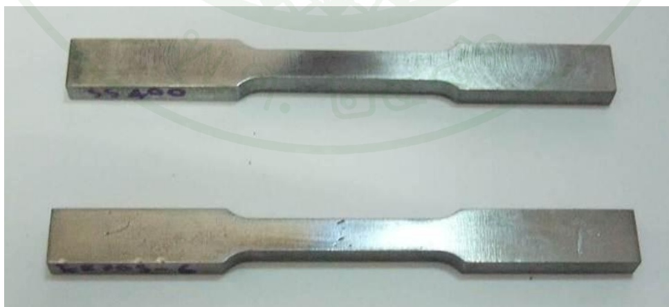
ภาพที่ 54 แสดงชิ้นงานทดสอบแรงดึง
