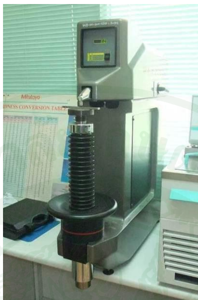
ภาพที่ 47 เครื่องทดสอบความแข็งยูนิเวอร์แซล ยี่ห้อ IDENTEC
