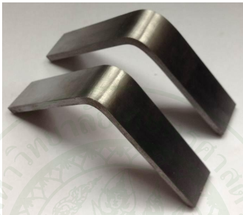
ภาพที่ 71 แสดงชิ้นงานหลังทดสอบการดัดโค้ง
