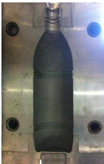
ภาพที่ 13 แม่พิมพ์ของขวดทดสอบ ขนาด 0.9 ลิตร
