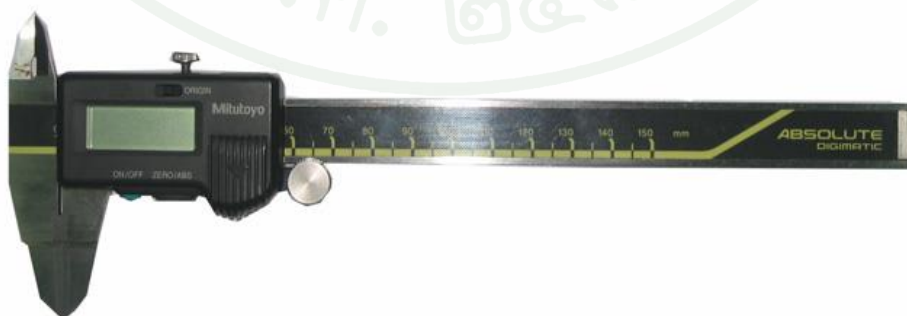
ภาพที่ 15 เวอร์เนียชนิดดิจิตอลสำหรับวัดความหนาของขวดทดสอบ
