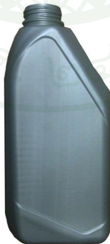
ภาพที่ 28 ขวดทดสอบแบบรูปทรงไม่สมมาตรรอบแกน ขนาด 1 ลิตร
