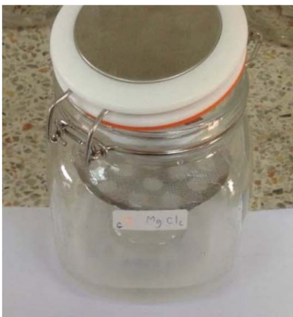
ภาพที่ 3.5 การหา Water vapor Resistance (WVR)
