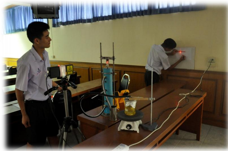
รูปที่ 5.1 การนำชุดทดลองเพื่อหาค่าสัมประสิทธิ์การขยายตัวทางความร้อนของ โลหะจากเทคนิค การเลี้ยวเบนของแสงเลเซอร์ใช้ในการเรียนการสอน
