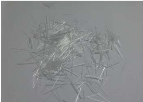
รูปที่ 9 ความยาวของเส้นใยแก้ว 1 เซนติเมตร
