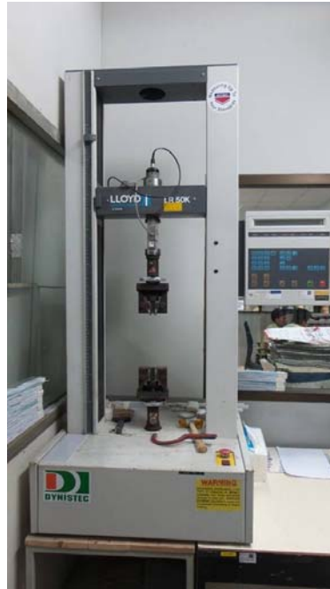
รูปที่ 8 การทดสอบคุณสมบัติทางกลของชิ้นตัวอย่างกระเบื้องไฟเบอร์กลาสด้วยเครื่อง LLOYD 20 KN โหลดเซลล์ขนาด 20 กิโลนิวตัน
