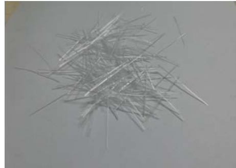
รูปที่ 10 ความยาวของเส้นใยแก้ว 2 เซนติเมตร
