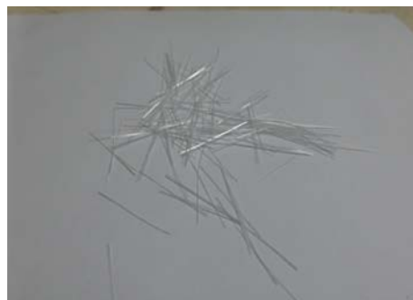
รูปที่ 11 ความยาวของเส้นใยแก้ว 3 เซนติเมตร
