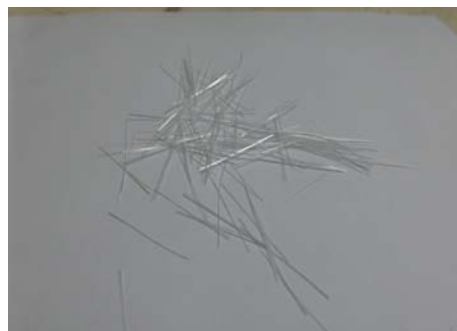
รูปที่ 3 ความยาวของเส้นใยแก้ว 3 เซนติเมตร
