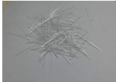
รูปที่ 2 ความยาวของเส้นใยแก้ว 2 เซนติเมตร
