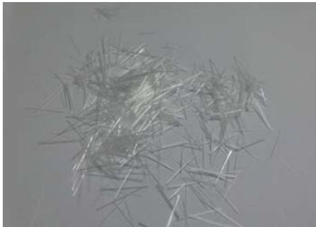
รูปที่ 1 ความยาวของเส้นใยแก้ว 1 เซนติเมตร
