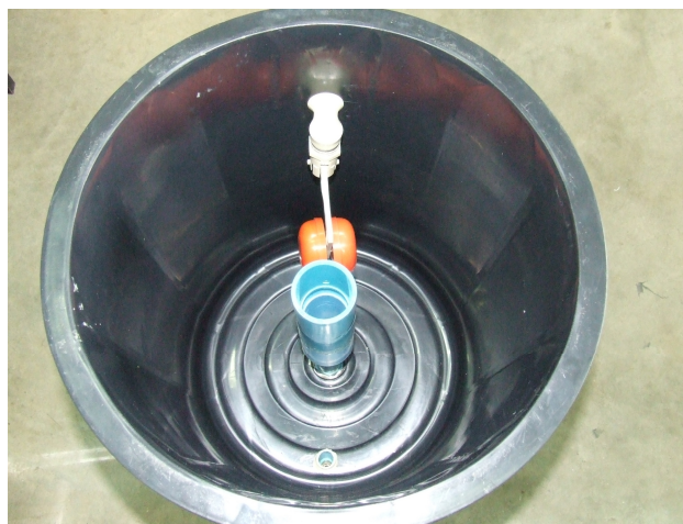
รูปที่ 3.14 ถังเติมน้ำด้านบนของระบบหมุนเวียนน้ำด้วยพลังงานความร้อน ระบบที่ 2
