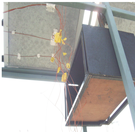
รูปที่ 3.7 การติดตั้งสายเทอร์โมคัปเปิลชนิด K ระบบที่ 1
