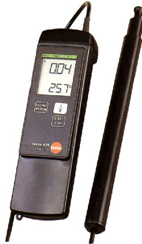
รูปที่ 3.9 อุปกรณ์วัดความเร็วลม ระบบที่ 1
