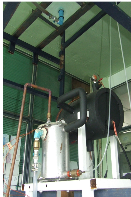
รูปที่ 3.11 การติดตั้งอุปกรณ์ทดลองเข้ากับโครงสร้างของระบบหมุนเวียนน้ำด้วยพลังงานความร้อนระบบที่ 2
