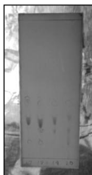
รูปที่ 4.4 สีที่เกิดขึ้นบนแผ่นโครมาโทกราฟีที่ชุบด้วยแอนิซอลดีไฮด์รีเอเจนต์
