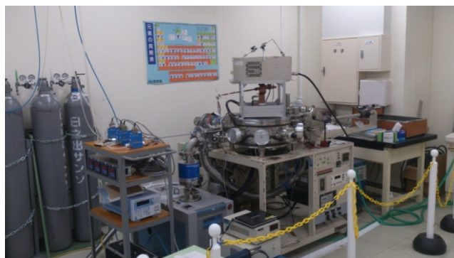
รูปที่ 3.4 เครื่องพลาสมาแบบไอระเหยเคมี
