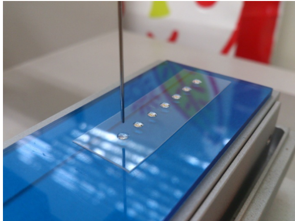
รูปที่ 3.19 การทดสอบสมบัติการชอบน้ำ
