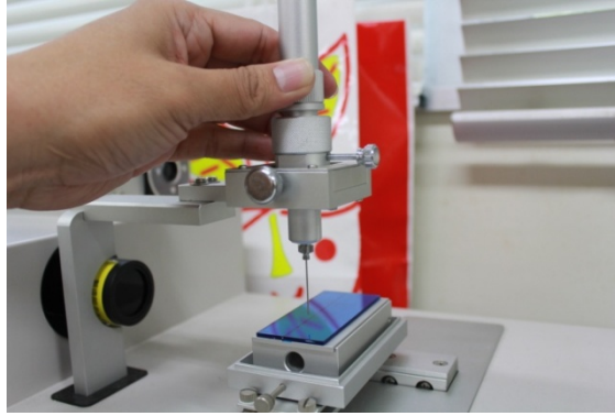
รูปที่ 3.17 เข็มที่ใช้ทำหยดน้ำในการทดสอบ
