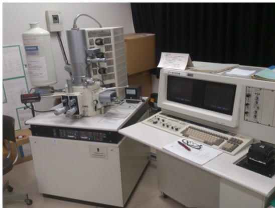
รูปที่ 3.7 กล้องจุลทรรศน์อิเล็กตรอนแบบส่องกราด
