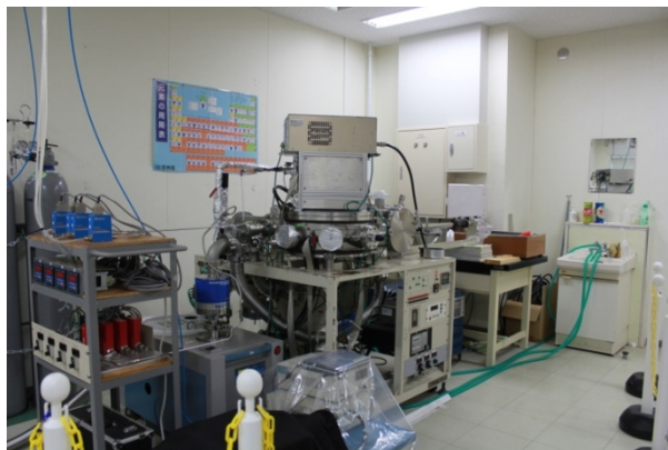
รูปที่ 3.14 ระบบพลาสมาแบบ Low-pressure high-frequency plasma chemical vapor deposition
