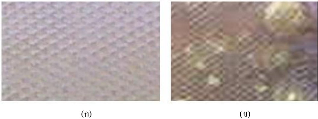
รูปที่ 3.2 เปรียบเทียบลายพื้นผิวของ (ก)แผ่นยางรมควันคุณภาพ และ (ข)แผ่นยางที่มีฟองอากาศ
