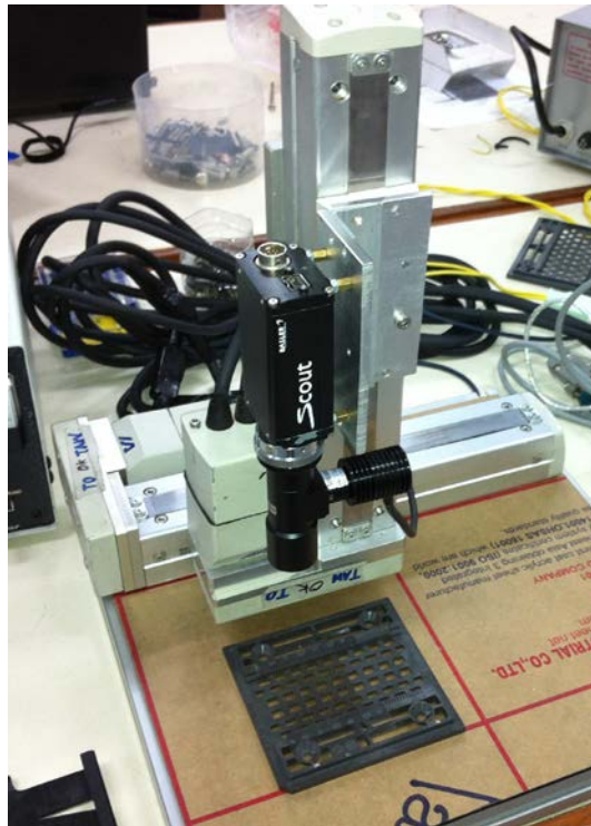
รูปที่ 4.3 กล้อง Basler scA750-60fm ที่ทำการยึดติดกับอุปกรณ์ปรับระยะ
